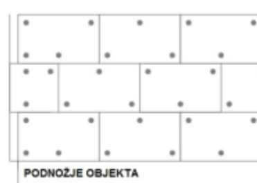
5 pričvrstnica/ploča ili 8 kom/m 2 fasade
