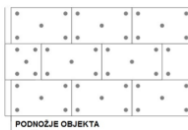
5 pričvrstnica/ploča ili 8 kom/m 2 fasade
