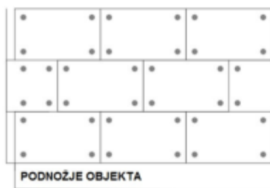
4 pričvrstnice/ploča ili 6 kom/m 2 fasade
